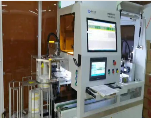
自动化贴标 设备可自动上料,扫码、打标、贴标、复核
