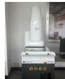
全自動影像測量儀 自動變倍鏡頭0.7~4.5X 90mm工作視距 解析度 0.0005\text{mm}
