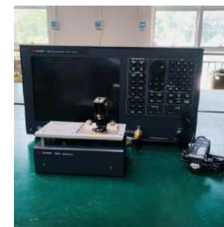
向量網路分析儀 頻率支援5Hz~3 GHz/50或75Ω 傳輸/反射或S參數測試
