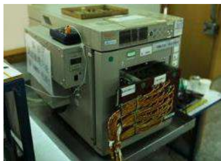
自製整合多台測試設備試驗箱 低溫可達 -60^{\circ}\text{C} ，Labview開 發控制程式，實現資料自動採集
