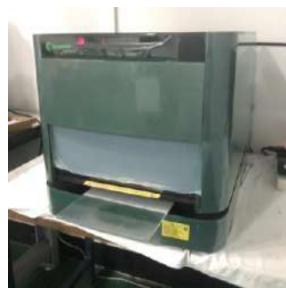
臺式X射線螢光鍍層測厚儀 檢測元素範圍：13號鋁~92號鉍 每層可分析10種元素
