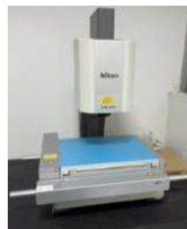
Nikon 2.5D投影儀 最高分辨力達 0.1\mu\text{m}
