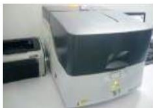
SHIMADZU 螢光光譜儀 測量ROHS指令中所有有害物質
